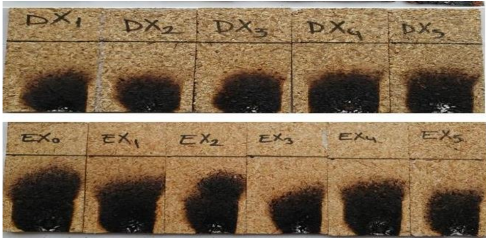
Şekil 1. Dolomit ilavesiyle üretilmiş ve tek alev kaynağına maruz kalmış levhaların davranışı
