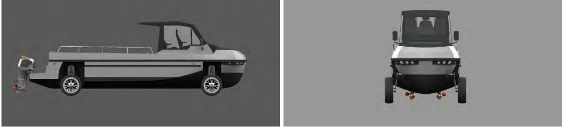
Şekil 2.4. Amfibi teknenin profil ve önden görünüşü
