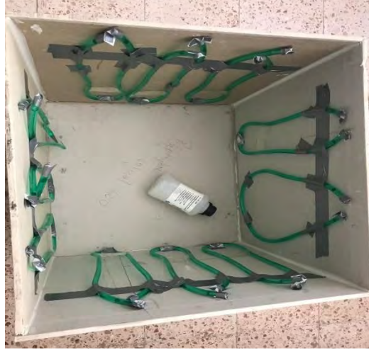
Şekil 3. Odaya yerleştirilen silikon hotrumlar ve polyethylene glycol 600
