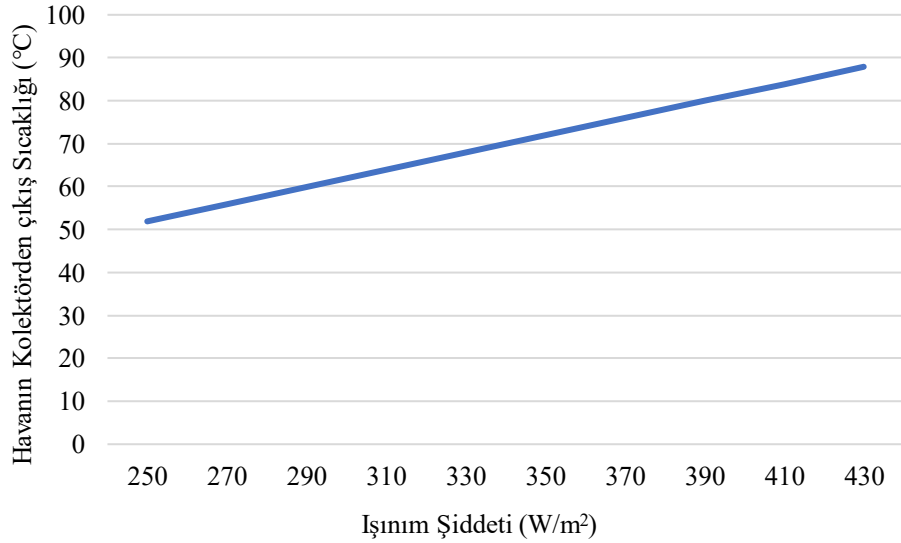
Şekil 3. Havanın kolektörden çıkış sıcaklığının ışınım şiddetine göre değişimi
