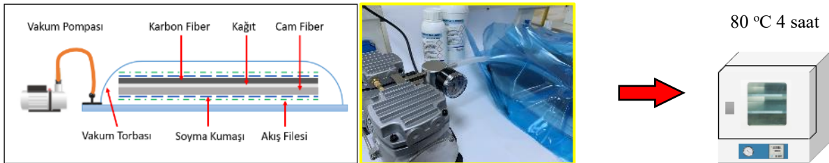
Şekil 4. Hibrit kompozitin üretim aşamalarının şematik gösterimi
