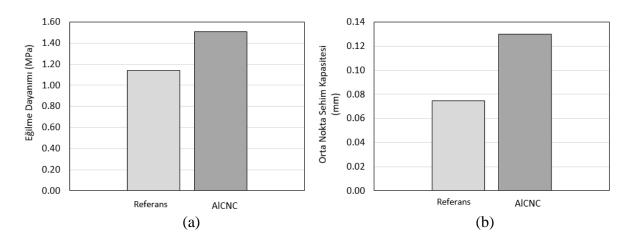
**Şekil 4.** a) Eğilme Dayanımı, b) Orta nokta sehim kapasitesi
