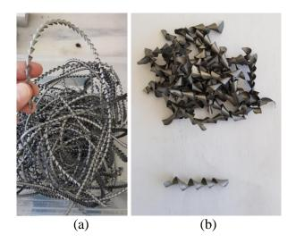
Şekil 1. a) CNC tekniği sırasında açığa çıkan alüminyum atığı, b) Kırpılmış atık alüminyum
